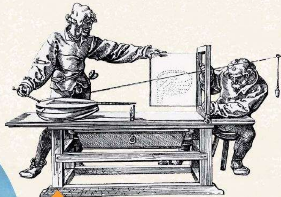
2 Instrument de mesure d'Albrecht Dürer (1471-1528). Il permettait d'obtenir une perspective correcte d'un objet. Gravure sur bois, 1525 Nuremberg.
